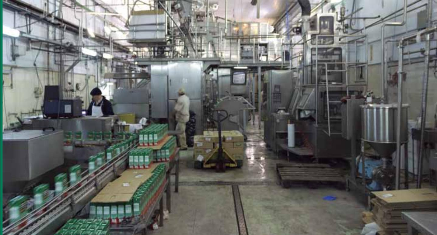
El proceso de la pulpa de tomate es así: viene una pasta casi seca en tambores, la disolvemos, y después pasa a un proceso de esterilización, pasteurización y de ahí al sistema de envasado aséptico, y sin tocar el aire se introduce en un envase que también está esterilizado.
